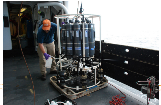
Se conecta un tubo a cada botella Niskin en esta roseta CTD para transferir muestras de agua a jarras de plástico para su procesamiento. Imagen por cortesía de NOAA Ocean Exploration/BOEM/USGS.
